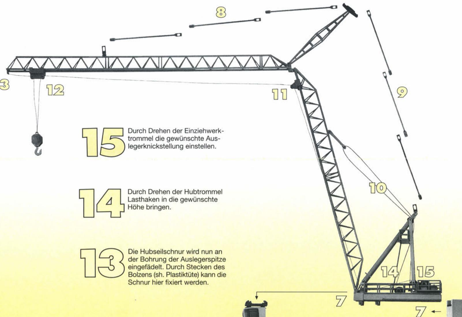
**15** Durch Drehen der Einziehwerk-trommel die gewünschte Aus-legerknickstellung einstellen.
