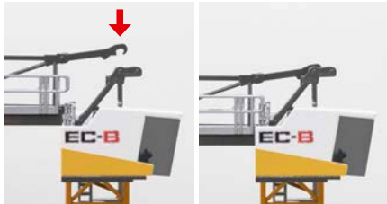
Gegenausleger (ohne Ballast) an Kompaktkopf stecken/ Connect the counter-jib (without ballast) to the compact head
