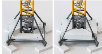
Auflegen der trapezförmigen Zentralballastplatten/ Add the trapezoidal central ballast slabs
