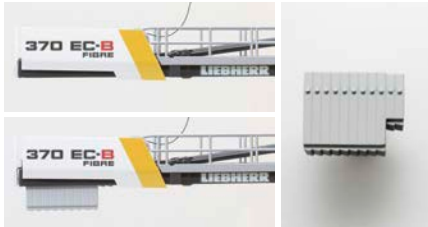
Gegenballast einsetzen/ Insert the counter-ballast
