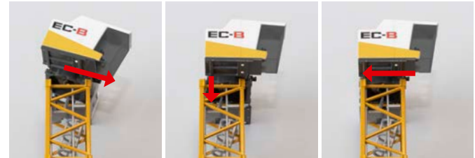
Kompaktkopf/Drehbühne mit KUD-Auflage in Turm einschieben/ Insert the compact head/slewing platform with slewing ring support into the tower
