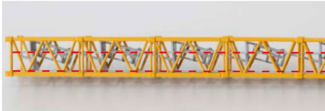
Weitere Turmabschnitte einschieben, Position der LiUP-Schienen beachten/ Insert further tower sections, pay attention to the position of the LiUP rails
